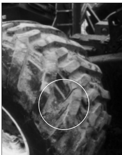
Abb. 1: Starke mechanische Beschädigungen an der Lauffläche eines wassergefüllten Reifens.
