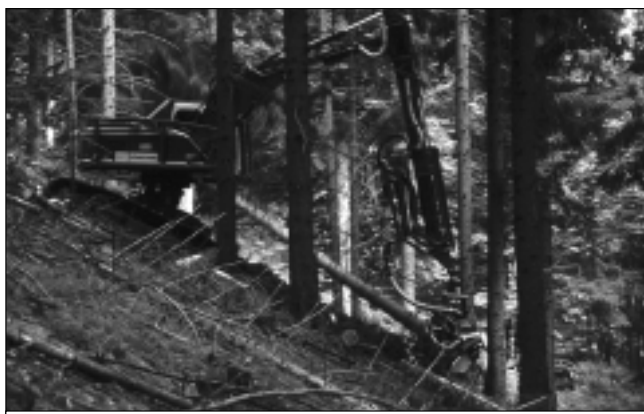
Der Raupenharvester mit getiltetem, waagrechtem Oberwagen.
