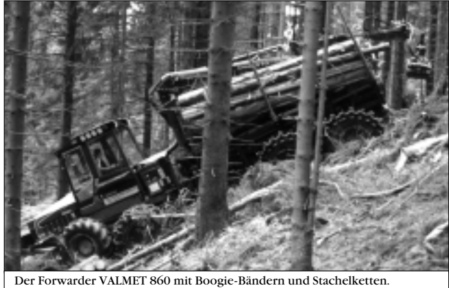
Der Forwarder VALMET 860 mit Boogie-Bändern und Stachelketten.
