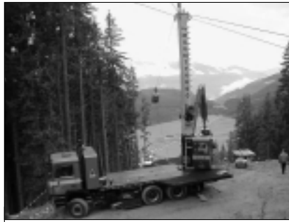
Abb. 2: Kombinationsmaschine zur weitgehenden Mechanisierung der Holzernte
