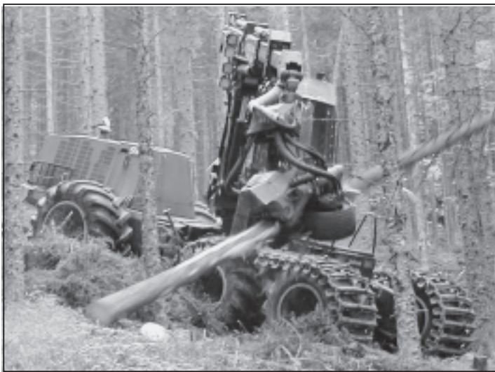
Kranvollernter als leistungsfähige, ergonomisch günstige und sichere Alternative zu motormanuellen Verfahren
