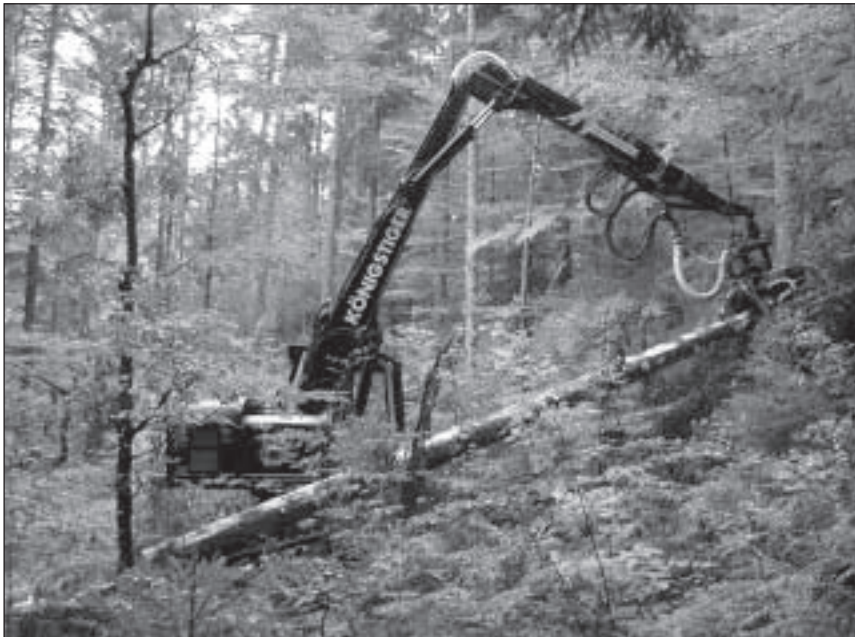
Der Raupenharvester IMPEX KÖNIGSTIGER bei der Aufarbeitung
