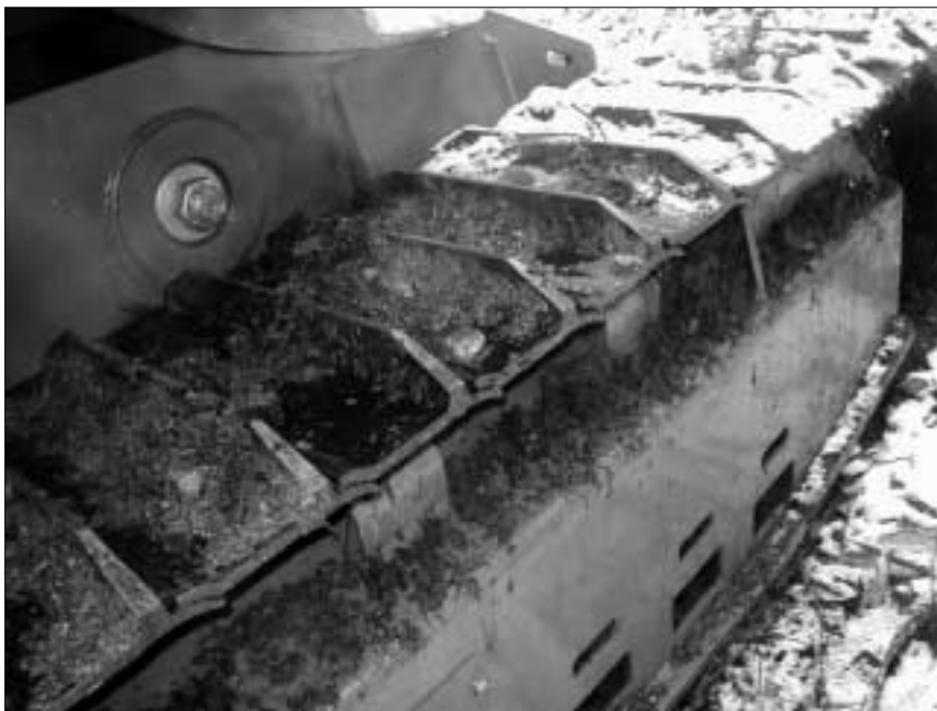
Raupenbänder mit hohen Metallstegen können flachstreichende Wurzeln beschädigen
