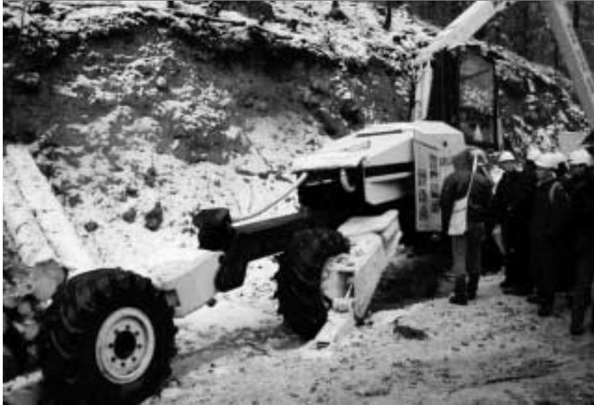
Die Kombination Räder und Schreitarme sollen für höchste Geländetauglichkeit sorgen
