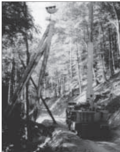
Seilkran Valentini V 6001M121C aufgebaut auf LKW
