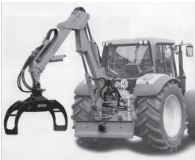
Rückekran RITTER Typ DK 4.5 für Dreipunktanbau
