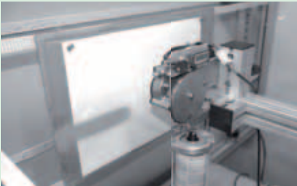
Abb. 2: Prüfstand zur Bestimmung der Randschärfe
