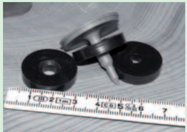
Abb. 2: Transponderträger und Transponder (Quelle: Holzmann, FVA BW)
